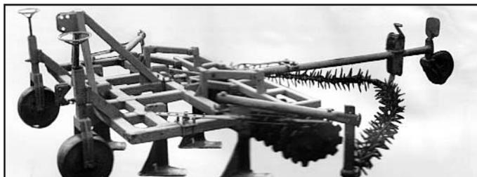
Застосування ґрунтообробних агрегатів ВАТ „Хмільниксільмаш“ дає можливість за один прохід біологічно підготувати ґрунт до сівби, що дає величезну економію трудових і матеріальних ресурсів. Окупність цих агрегатів – 20-30 робочих днів. Високопродуктивними (до 100 га за день) є також розкидачі міндобрив МВД-900 та МВД-0,5, які можна широко застосовувати, як сівалки для трав і зернових. Ними можна сіяти навіть за дощової погоди.
